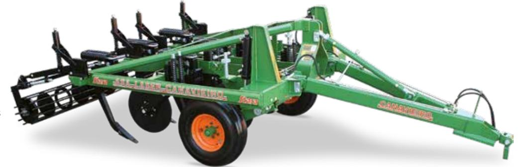
El Asa Laser Canavieiro fue desarrollado específicamente para trabajos pesados en el cultivo de caña de azúcar y proyectado para romper compactaciones de hasta 62 cm de profundidad. Posee un sistema de desarme automático, sus discos son independientes y regulables, dimensionados para el corte de grandes cantidades de restos de cultivos.
