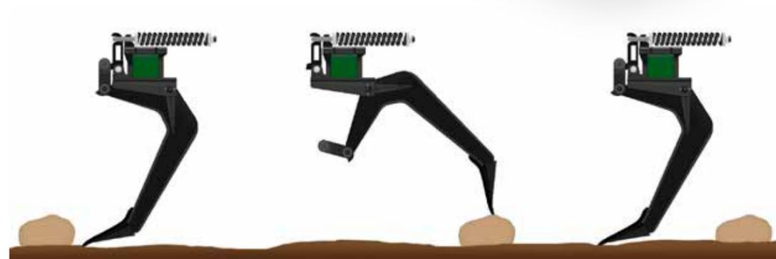
El sistema de Desarme Automático protege el implemento y el tractor de impactos bruscos y dispensa el cambio del pasador de seguridad.
