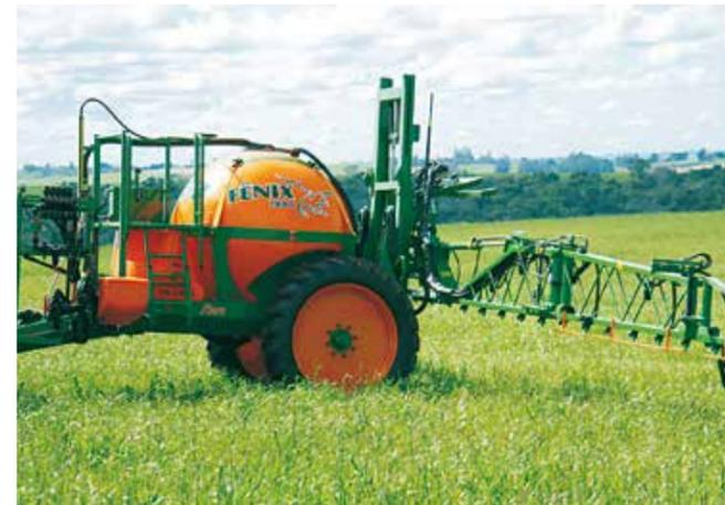
Es el único pulverizador del mercado con capacidad de 2 mil litros y con barras de 18, 21 o 24 metros, con un alto grado de tecnología agregada que le proporciona mayor autonomía y rendimiento.
