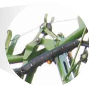
Cable de acero de apertura altamente resistente con 8 mm de espesor.
