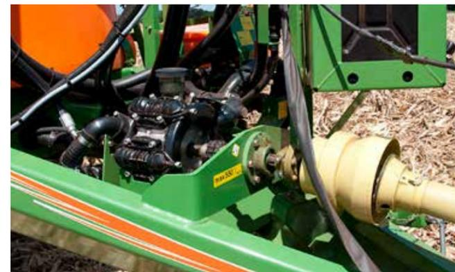
Los pulverizadores de arrastre Fênix H y E poseen bomba de pulverización con sistema de pistón y de membranas. Con un sistema de cojinete de seguridad que evita impactos directamente en la bomba, aumentando su vida útil.
