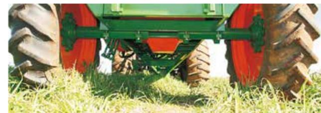
Conjunto de ruedas Cross con regulación de apertura de 1,80 a 2,10 metros o 2,10 a 2,40 metros con un fácil ajuste de la posición de las ruedas que proporciona su adecuación entre las líneas del cultivo o de las ruedas del tractor. La altura del chasis en relación al suelo (vano libre) es de 70 centímetros.
