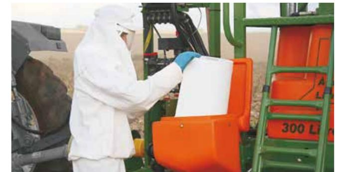
Mezclador y limpia frascos con succión de hasta 250 l / min, con opción de reabastecimiento de combustible directo con el propio pulverizador. Esto facilita el reabastecimiento en cualquier situación de trabajo, no vertiendo residuos químicos en el ambiente.
