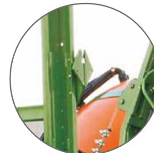
Posee bloqueo en el conjunto de cuadro y barras cerradas lo que evita trepidaciones en el transporte del pulverizador proporcionando más seguridad.
