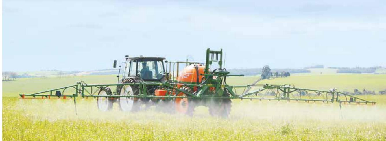
Los pulverizadores Fênix 2000 poseen reservorio esférico con capacidad de 2 mil litros, proporcionando más estabilidad durante la aplicación.
