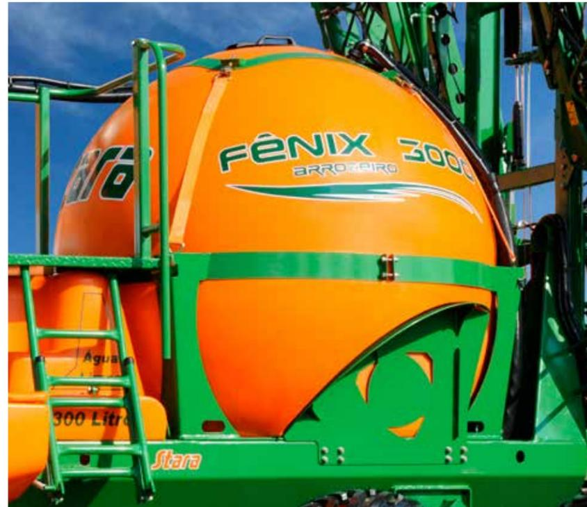
Reservorio esférico de 3.000 litros con mayor resistencia estructural, autolimpiante, con "rompe-olas" y estabilizador de productos.
