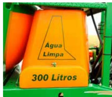
Reservorio de agua limpia con gran capacidad (300 litros) para la limpieza de las tuberías, boquillas y comandos en la propia labranza.
