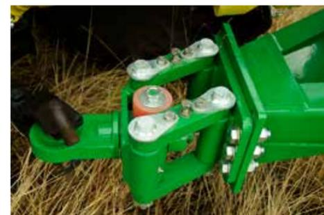
El enganche oscilante evita movimientos laterales de la barra de tracción del tractor, no generando avances y retrocesos en las extremidades de las barras.
