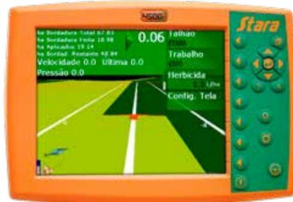
El Fênix 3000 Arrozeiro está equipado con el Topper 4500 que posee un controlador de flujo, DGPS, apagado automático de secciones y piloto automático (opcional).
