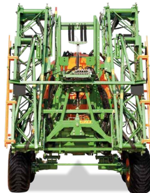
Apertura electrohidráulica de las barras, lo que facilita la operación mismo con tractores combinados. Tecnología aeronáutica en la construcción de las barras.
