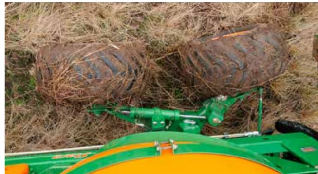
Los Fênix poseen un sistema tándem autodireccional que evita el derrape lateral de las ruedas en curvas y tensiones en la estructura de la máquina. Poseen también ruedas con regulación de ancho. Con todas estas ventajas es posible el paso más suave por la "taipa" de arroz, evitando movimientos bruscos en las barras.
