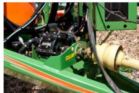
Bomba de pulverización con sistema de pistón y membrana, flujo de 220 l/minuto, a 540 rpm. Sistema de cojinete de seguridad que evita impactos directamente en la bomba.
