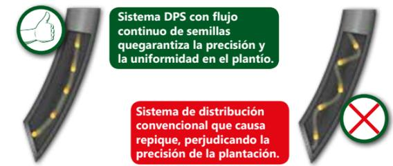
Sistema DPS con flujo continuo de semillas que garantiza la precisión y la uniformidad en el plantío.
