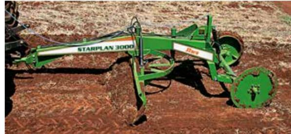
Ruedas guía, importante opcional para la construcción de terrazas y evitar el deslizamiento lateral.
