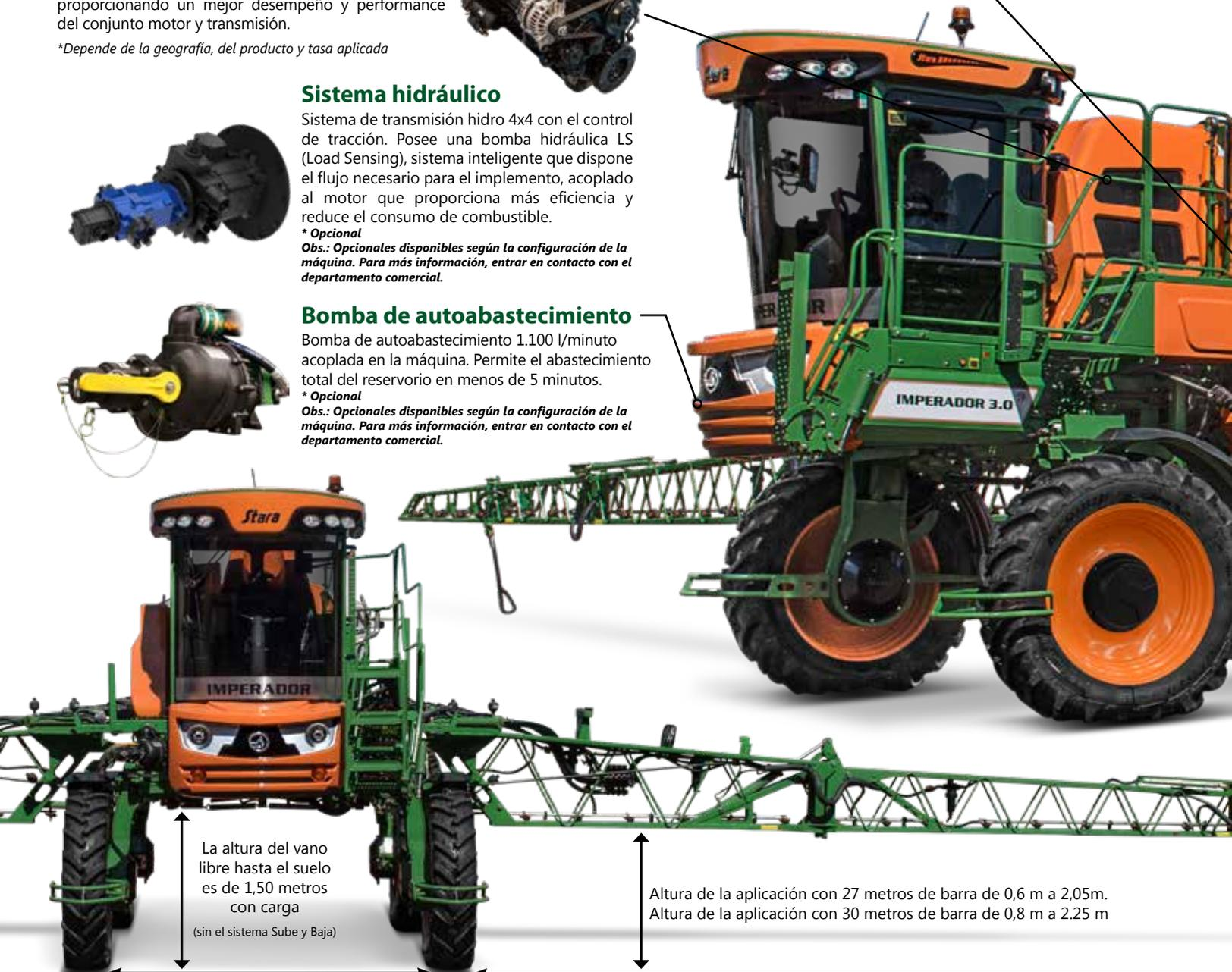
La altura del vano libre hasta el suelo es de 1,50 metros con carga
