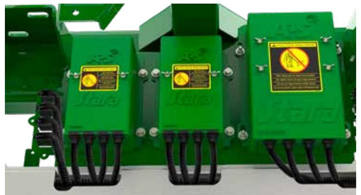
El Imperador 3.0 posee un sistema eléctrico compuesto por chicotes modulares, integrados a la máquina y debidamente posicionados en el interior de electroductos de protección, evitando la exposición y el contacto directo con productos corrosivos e intemperies, aumentando así la protección del producto. Aplicación de uniones derivadas en puntos críticos de los chicotes, además del uso de los mejores conectores del mercado con sellado resistente a la aplicación en el campo.
