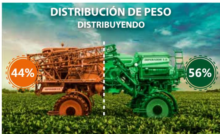
Como las barras están ubicadas en el centro de la máquina, el peso está distribuido 44% en la parte delantera y 56% en la parte trasera y 50% en la parte delantera y 50% en la trasera para la pulverización, aumentando aún más su estabilidad.
