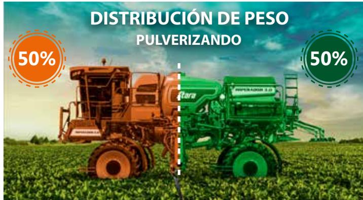
Como las barras están ubicadas en el centro de la máquina, el peso está distribuido 50% en la parte delantera y 50% en la trasera para la pulverización y 44% en la parte delantera y 56% en la parte trasera para la distribución, aumentando aun más su estabilidad.
