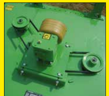
La transmisión se asegura por 2 correas trapecoidales que accionan los diferentes rotores
