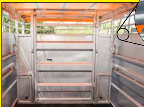
Puerta interior equipada con un mango para una apertura con toda seguridad desde el exterior
