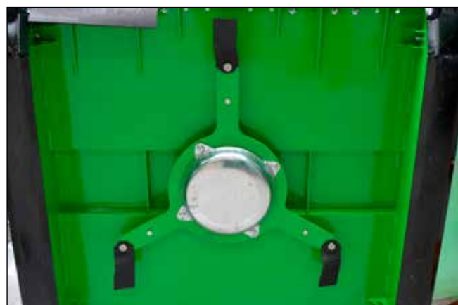
Las trituradoras BEV están equipadas con un rotor que soporta 3 cuchillos de "tipo TD"
