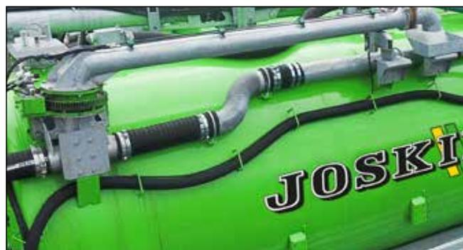
Otra alternativa para la transferencia de purín, el brazo de descarga 8" permite a la cuba de transporte alimentar un contenedor tampó o una cuba de esparcimiento por medio de un orificio superior.
