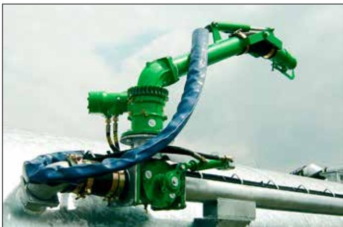
Agitación volumétrica con retorno en cuba para válvula de 3 vías hidráulica
