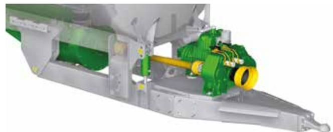
Accionamiento mecánico vía caja de las 2 bombas
