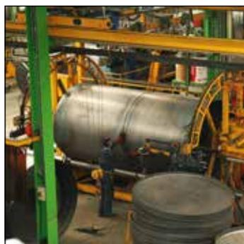
*Ensamblaje de las juntas y de los fondos*
