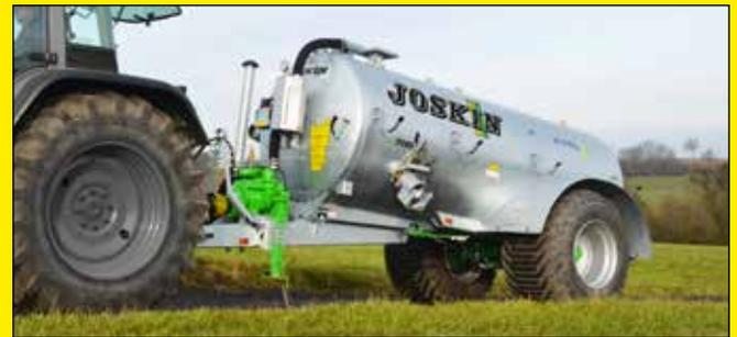
Los modelos 7000 S y 8000 S están equipados en estándar con un encastramiento de las ruedas. Por consiguiente es posible montar neumáticos de un ancho de 800 mm y de un diámetro de 1.500 mm, sin que el ancho total sobrepase 2,55 m. El encastramiento es más largo que la rueda con fines de poder desplazar el eje y así repartir idealmente la carga.
