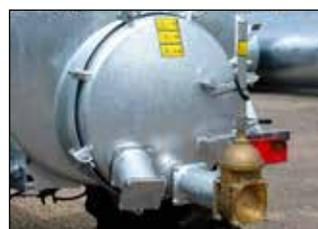
Orificio de acceso sobre bisagra  $\varnothing$  850 mm (sobre MODULO2 sin contrafuerte)
