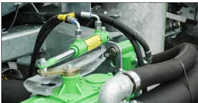
*Inversor de bomba hidráulica*
