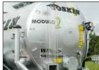
Indicador de nivel comunicante transparente  $\varnothing$  150 mm
