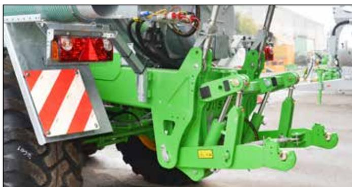
*Elevador Lift integrado (elevador completamente integrado dentro del chasis) sobre QUADRA, X-TREM, VOLUMETRA, TETRAX y EUROLINER*
