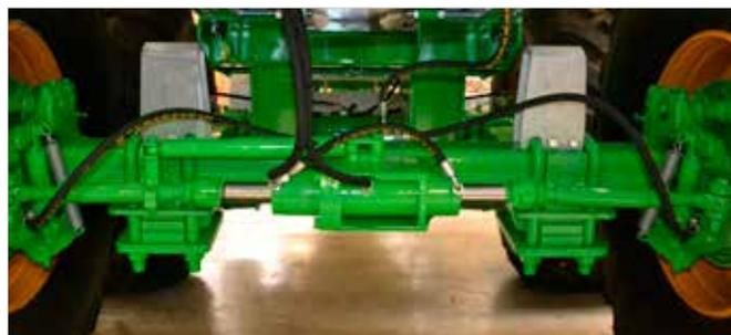
**Eje seguidor** (50 % direccional)
