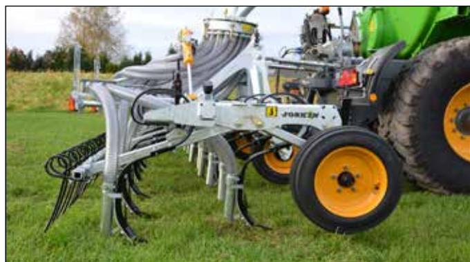
TERRAFLEX/2 provisto de una grada niveladora
