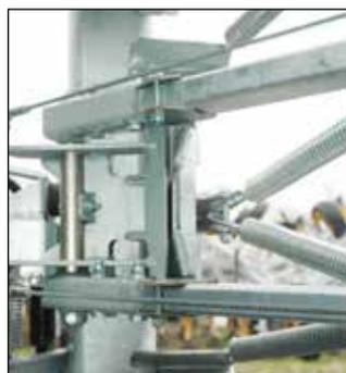
Cuando el inyector es replegado, los elementos situados sobre los brazos superiores se mantienen en posición por un sistema de bloqueo. Una simple muesca impide a cada uno de los elementos efectuar una rotación sobre su eje y recaer. Los elementos quedan muy rígidos con respecto a las vibraciones sufridas durante el transporte.
