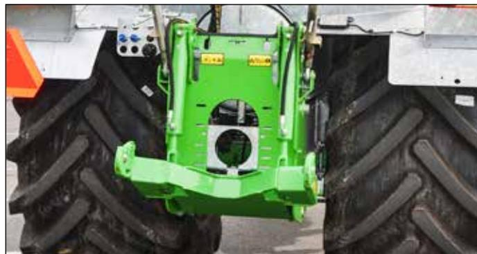
*Elevador L600 sobre COBRA (fijado por 4 ejes cónicos para hacer de éste un conjunto robusto)*
