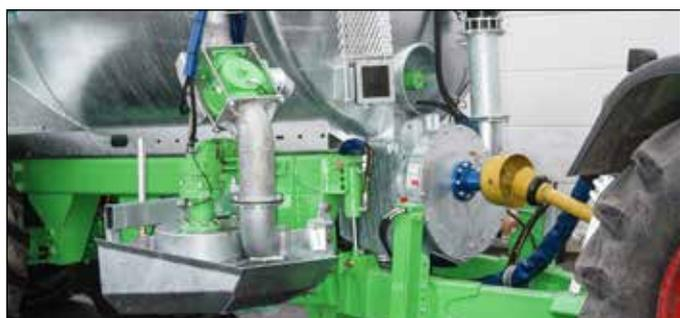
DUAL-STORM con accionamiento mecánico de la bomba de expulsión
