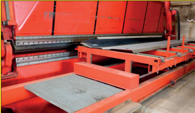
Plegadora con mando digital de una fuerza de presión de 600 toneladas
