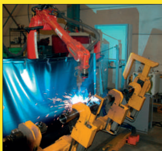
Robot de soldadura
