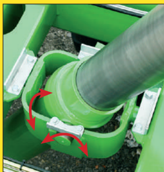
Cuadro con doble oscilación dentro del cual se coloca el cilindro
